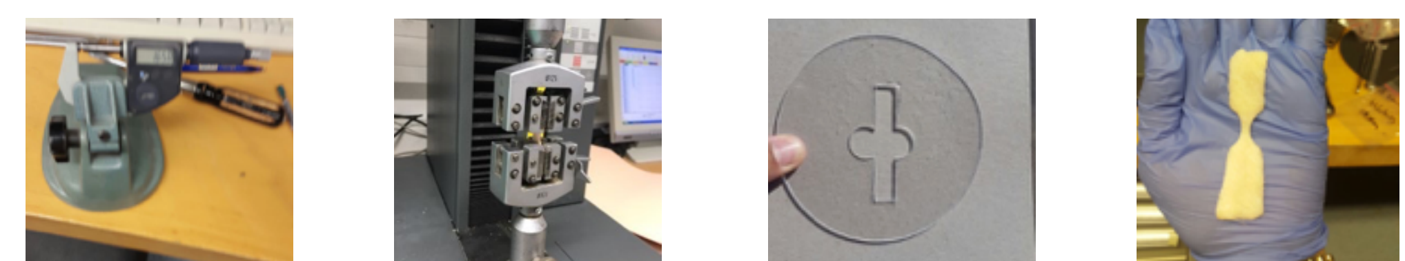
Abb. 3: Mikrometerschraube, Zugprüfmaschine, Schablone, Hautprobe
